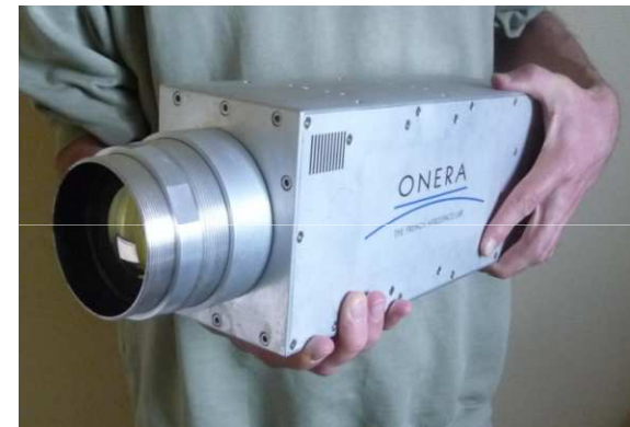
Instrument opérationnel avec optique de tête (refroidissement par machine cryo)
