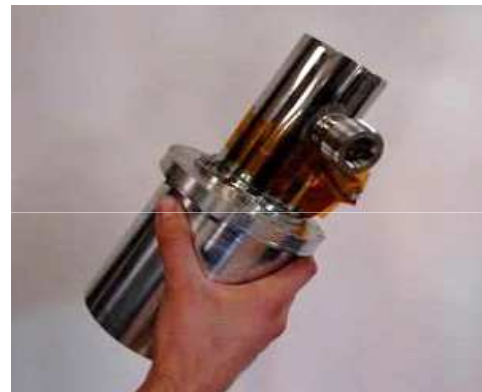
Intégration devant un détecteur IR dans un cryostat de laboratoire (refroidissement par bain d'Azote liquide)
